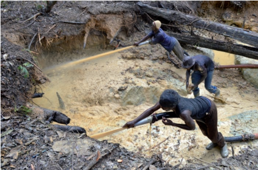
Un site d'orpaillage clandestin sur le haut Maroni exploité à l'aide de lances-monitors. Cliché de Thierry Nicolas, 2015
